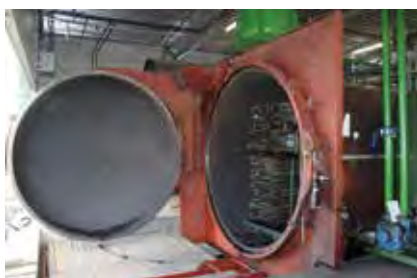
Dettaglio del trattamento in autoclave
